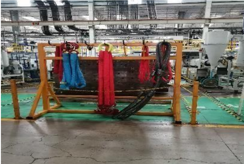
Figura 4.4 Estantería de almacenamiento para estrobos y eslingas.
