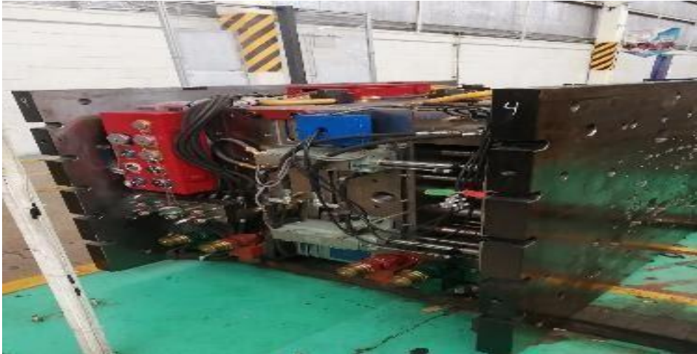
Figura 4. 10. Identificación de molde por código de colores.
